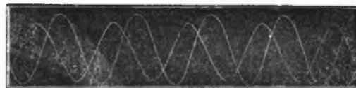
Fig. 3. Oscillogram van de input en output waarden van den in fig. 2 geschetsten versterker
